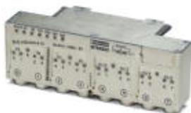
Устройство цифрового ввода-вывода для INTERBUS; оптоволоконная технология, скорость передачи данных 500 кбод, 8 входов (24 В постоянного тока), 8 выходов (24 В постоянного тока, 0,5 А), подключение датчиков/исполнительных элементов посредством 5-контактных гнезд M12, прочный металлический корпус, степень защиты IP67
