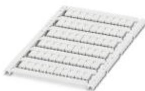
Маркировка для клеммных модулей, возможен заказ: в пластинах, белый, надписи в соответствии с требованиями заказчика, тип монтажа: крепление в высоких пазах для табличек, для клемм шириной: 6,2 мм, размер маркировочного поля: 5 x 7,4 мм
