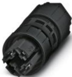
Разъем, Тип подключения QUICKON, полюсов: 3+PE, 1 мм<sup>2</sup> ... 2,5 мм<sup>2</sup>, 690 В, 20 А, черный, диапазон диаметра кабеля: 6 мм ... 10 мм
