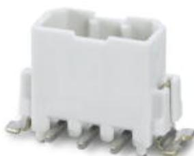
Корпусная часть для печатных плат, номинальный ток: 6 A, расчетное напряжение (III/2): 160 В, полюсов: 8, размер шага: 2,5 мм, цвет: белый, поверхность контакта: олово, монтаж: SMD пайка, Артикул с защитными стопорными штифтами
