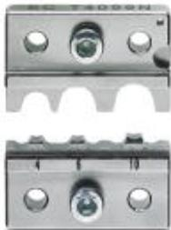
Матрица для автом. обжимного устройства CF 500, для кабельных наконечников с отверстием 4 ... 10 мм<sup>2</sup>, 4 мм<sup>2</sup>: наружный Ø 5 мм, внутренний Ø 3 мм, 6 мм<sup>2</sup>: наружный Ø 6,5 мм, внутренний Ø 3,5 мм, 10 мм<sup>2</sup>: наружный Ø 7 мм, внутренний Ø 4,5 мм
