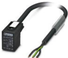
Кабель для датчика / исполнительного элемента, 3-полюсн., ПВХ, черный RAL 9005, свободный конец, к Штекер типа BI для электромагнитного клапана (11 мм), с 1 светодиод, подключение с помощью Диод Зенера, длина кабеля: 10 м
