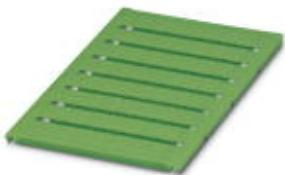
Маркировка для клеммных модулей, Пластина, зеленый, без маркировки, маркируется с помощью: BLUEMARK ID COLOR, BLUEMARK ID, BLUEMARK CLED, PLOTMARK, CMS-P1-PLOTTER, тип монтажа: крепление в высоких пазах для табличек, для клемм шириной: 8,2 мм, размер маркировочного поля: 7,6 x 10,5 мм
