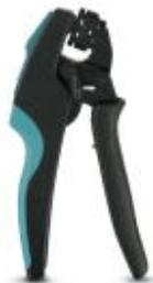
Клещи для опрессовки, лазерная маркировка по данным заказчика, тип контактов: изолированные и неизолированные кабельные наконечники, стандарты/нормативные документы: DIN 46228-1, DIN 46228-4, сечение мин.: 0,14 мм<sup>2</sup>, сечение макс.: 10 мм<sup>2</sup>, для кабельных гильз TWIN до 2 x 4 мм<sup>2</sup>, автоматический подбор сечения, поворотная матрица, боковой и фронтальный ввод, вид обжима: Форма обжима - трапеция, черный
