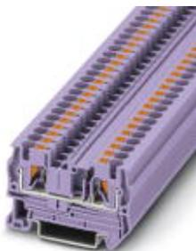
Проходные клеммы, номинальное напряжение: 800 В, номинальный ток: 32 А, тип подключения: Зажимы Push-in, количество точек подсоединения: 2, сечение: 0,2 мм<sup>2</sup> - 6 мм<sup>2</sup>, AWG: 24 - 10, ширина: 6,2 мм, высота: 35,3 мм, цвет: фиолетовый, тип монтажа: NS 35/7,5, NS 35/15
