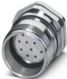
Приборные соединители с резьбой для ввинчивания M20 x 1,5, прямой, экранирован.: есть, Винтовой зажим, M23, Полясов: 8+1, тип контактов: Розетка, Обжим, Аксиальное уплотнительное кольцо, Центральное крепление, Толщина стенок, мин.: 0,8 мм, Толщина стенок, макс.: 6,5 мм
