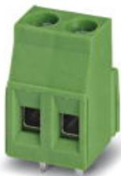
Клеммы для печатной платы, номинальный ток: 24 А, номинальное напряжение: 400 В, размер шага: 5 мм, полюсов: 5, тип подключения: Винтовой зажим с натяжной гильзой, монтаж: Пайка волной припоя, направление подключения, проводник/печатная плата: 0 °, цвет: зеленый. Возможна установка в ряд модулей с различным количеством полюсов (контактов)!
