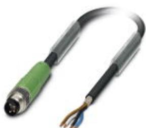
Кабель для датчика / исполнительного элемента, 4-полюсн., PUR без галогенов, темно-серый RAL 7021, экранирован., Штекеры прямое M8, к свободный конец, длина кабеля: 3 м
