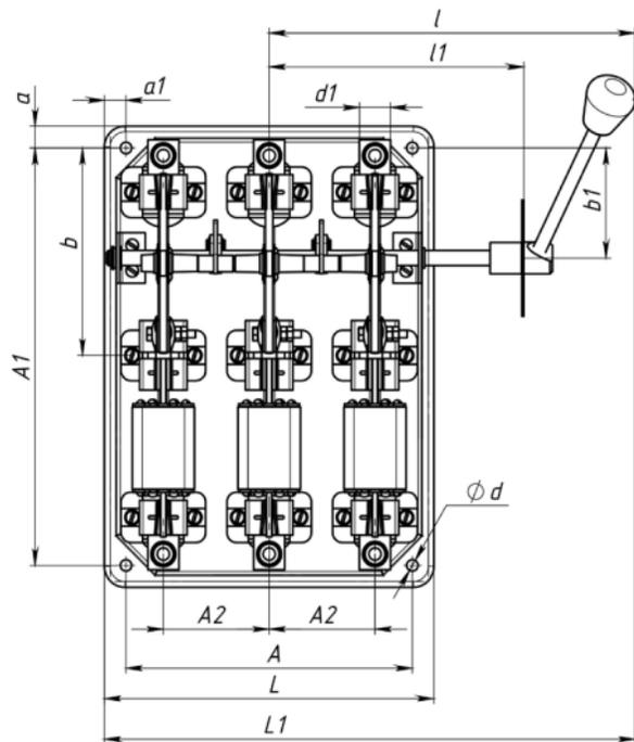
**Рисунок Б.2** – Разъединители - предохранители с боковой смещенной рукояткой на токи до 630 А
