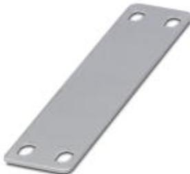
Алюминиевая табличка, возможен заказ: поштучно, алюминиевый, надписи в соответствии с требованиями заказчика, тип монтажа: Монтаж кабельной стяжкой, диаметр кабеля: > 4,6 мм, размер маркировочного поля: 60 x 15 мм
