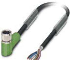
Кабель для датчика / исполнительного элемента, 6-полюсн., PUR без галогенов, темно-серый RAL 7021, экранирован., свободный конец, к Гнездо угловой M8, длина кабеля: 5 м
