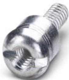
Фиксирующий винт, резьба 4-40 UNC, для применения при монтаже на переднюю стенку, макс. толщина корпуса 1,5 мм
