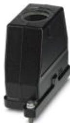
Сальниковый корпус B16, с винтовым креплением, материал: Алюминиевое литье под давл., длина кабеля: 1, прямое, высота: 110,5 мм, кабельный ввод: без, патрубков: Нет, 1x M40, защитная крышка: Нет, для железнодорожного транспорта, для повышенных требований окружения и ЭМВ, Серия HPR
