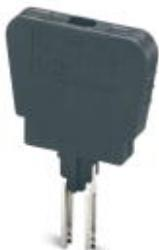
Штекерный держатель предохранителя, с индикатором для 12 В AC/DC, тип предохранителя: Стекло / керамика / ..., тип подключения: Штекерное подключение, номинальный ток: 6,3 А, номинальное напряжение: 12 В, ширина: 6,1 мм, тип предохранителей: G / 5 x 20, цвет: темно-серая
