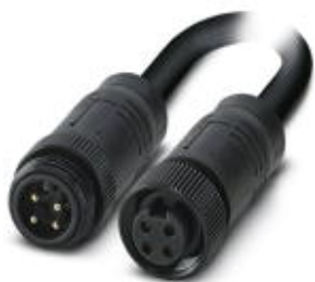
Силовой кабель, 4-полюсн., ПВХ, черный, Штекеры прямое 7/8"-16UNF, А - стандарт, к Гнездо прямое 7/8"-16UNF, длина кабеля: 10 м
