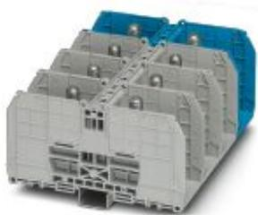
Болтовые клеммы, номинальное напряжение: 1000 В, номинальный ток: 520 А, тип подключения: Болтовые клеммы, количество точек подсоединения: 8, полюсов: 4, сечение: 25 мм<sup>2</sup> - 300 мм<sup>2</sup>, ширина: 219,2 мм, цвет: серый/синий, тип монтажа: NS 35/7,5, NS 35/15, непосредственное резьбовое
