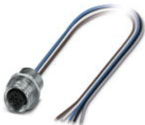
Встраиваемые разъемы, Универсальный, 5-полюсн., Гнездо, прямое, M12-Push-Pull, A-кодирование, Монтаж на передней стенке, M16 x 1,5, Отдельные проводники, длина кабеля: 0,5 м
