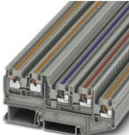
Клеммный модуль для подключения датчиков и исполнительных элементов, номинальное напряжение: 250 В, номинальный ток: 13,5 А, тип подключения: Зажимы Push-in, количество точек подсоединения: 5, сечение: 0,14 мм<sup>2</sup> - 1,5 мм<sup>2</sup>, AWG: 26 - 14, ширина: 3,5 мм, высота: 40 мм, цвет: серый, тип монтажа: NS 35/7,5, NS 35/15
