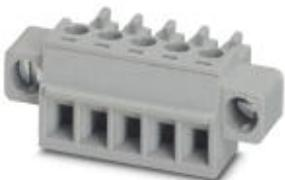
Разъемы для печатной платы, номинальный ток: 8 A, расчетное напряжение (III/2): 160 В, полюсов: 5, размер шага: 3,81 мм, тип подключения: Винтовой зажим с натяжной гильзой, цвет: бело-зеленый, поверхность контакта: олово
