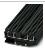
Проходные клеммы, номинальное напряжение: 800 В, номинальный ток: 32 А, тип подключения: Пружинный зажим, количество точек подсоединения: 4, сечение: 0,08 мм² - 6 мм², AWG: 28 - 10, ширина: 6,2 мм, цвет: черный, тип монтажа: NS 35/7,5, NS 35/15
