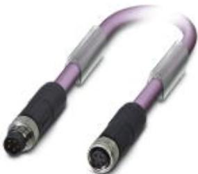
Системный кабель шины, CANopen®, DeviceNet™, 5-полюсн., PUR без галогенов, фиолетовый RAL 4001, экранирован., Штекеры прямое M8, к Гнездо прямое M8, длина кабеля: 15 м, Соединитель неэкранированный
