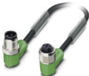
Кабель для датчика / исполнительного элемента, 3-полюсн., PUR без галогенов, темно-серый RAL 7021, Штекеры угловой M12, А-кодирование, к Гнездо угловой M12, А-кодирование, PIN 2+4 с переключкой, длина кабеля: 0,6 м
