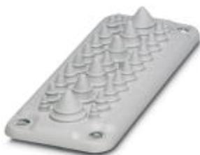
Панель кабельных вводов, количество проводов: 27, длина: 222 мм, ширина: 92 мм, высота: 29,5 мм, наружный диаметр проводника: 13x 10 мм ... 14 мм, цвет: серый
