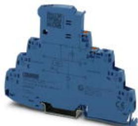
Защита от перенапряжений, со встроенным индикатором состояния и ножевыми размыкателями для трехпроводной сигнальной цепи Ex-i с общим опорным потенциалом. Для высокочастотных приложений. Непрямое заземление через газовый разрядник, поддержка HART. Рассчитано на использование в системе полевой шины согласно концепции FISCO.
