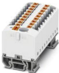
Распределительный блок, Горизонтально расположенный блок и интегрированное питание, Блоки можно шунтировать между собой, используя отверстия клеммы. Подходящие перемычки см. в принадлежностях, номинальное напряжение: 690 В, номинальный ток: 24 А, тип подключения: Зажимы Push-in, Зажимы Push-in, количество точек подключения: 19, сечение: 0,14 мм<sup>2</sup> - 4 мм<sup>2</sup>, AWG: 26 - 12, ширина: 56,5 мм, цвет: белый, тип монтажа: NS 15
