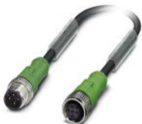
Кабель для датчика / исполнительного элемента, 4-полюсн., PUR без галогенов, отверженный излучением, устойчив к сварочному грату, оранжевый RAL 2003, Штекеры прямое M12, А-кодирование, к Гнездо прямое M12, А-кодирование, длина кабеля: 1 м
