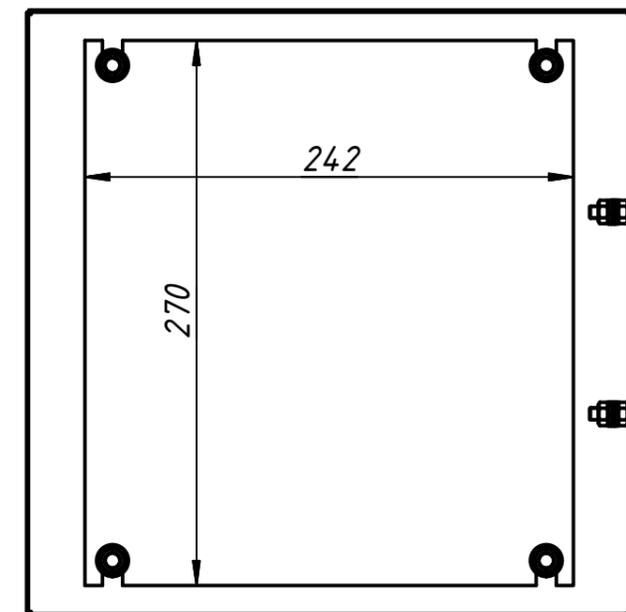
1. Корпус и дверь шкафа выполнены из нержавеющей стали AISI 304, S= 1 мм.
