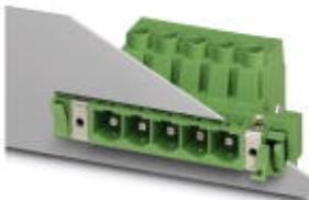
Проходной штекер, номинальный ток: 76 A, расчетное напряжение (III/2): 1000 В, полюсов: 3, размер шага: 10,16 мм, тип подключения: Винтовой зажим с натяжной гильзой, цвет: зеленый, поверхность контакта: Серебро
