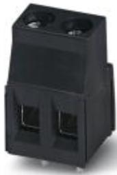
Клеммы для печатной платы, номинальный ток: 16 A, номинальное напряжение: 320 В, размер шага: 5 мм, полюсов: 2, тип подключения: Винтовой зажим с натяжной гильзой, монтаж: THR пайка, направление подключения, проводник/печатная плата: 0 °, цвет: черный. Данное изделие может применяться вместе с серией SMD в печах для пайки оплавлением припоя.
