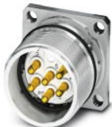
Приборный соединитель, передняя часть стенки, прямой, экранирован.: есть, для стандартной блокировки и SPEEDCON, M23, Полюсов: 6, тип контактов: Штифт, Выводы под пайку, Плоское уплотнение, 4x Ø 3,2, размер фланца: 25 мм x 25 мм
