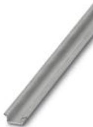
Несущая рейка без перфорации, Стандартный профиль, ширина: 15 мм, высота: 5,5 мм, согласно EN 60715, материал: Сталь, оцинкован., пассивирован., длина: 500 мм, цвет: серебристый
