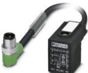
Кабель для датчика / исполнительного элемента, 3-полюсн., PUR без галогенов, темно-серый RAL 7021, Штекеры угловой M12 SPEEDCON, А-кодирование, к Штекер типа В для электромагнитного клапана (10 мм), с 1 светодиод, подключение с помощью Диод Зенера, длина кабеля: 3 м
