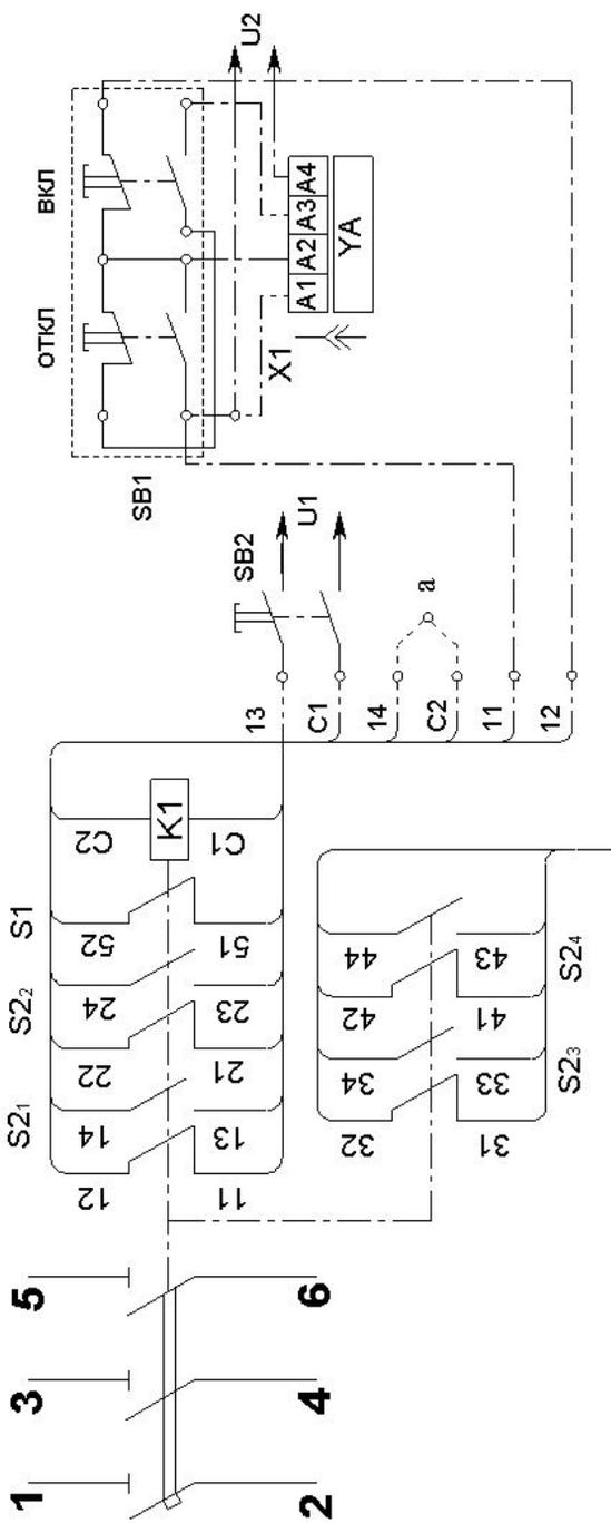
**Рисунок Г.2** – Выключатель с дополнительными сборочными единицами. Схема сигнального контакта S1 приведена для выключателя в коммутационном положении «отключено автоматически»
