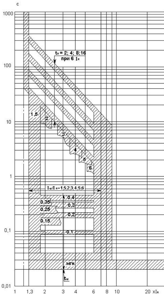
**Рисунок В.1** – Выключатель ВА53-43. Обрато-квадратичная зависимость
