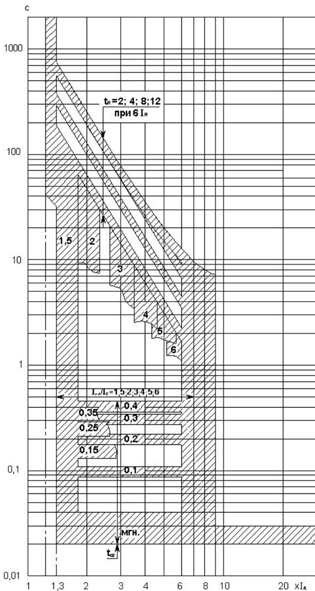
**Рисунок В.2** – Выключатель ВА53-43. Обрато-кубическая зависимость
