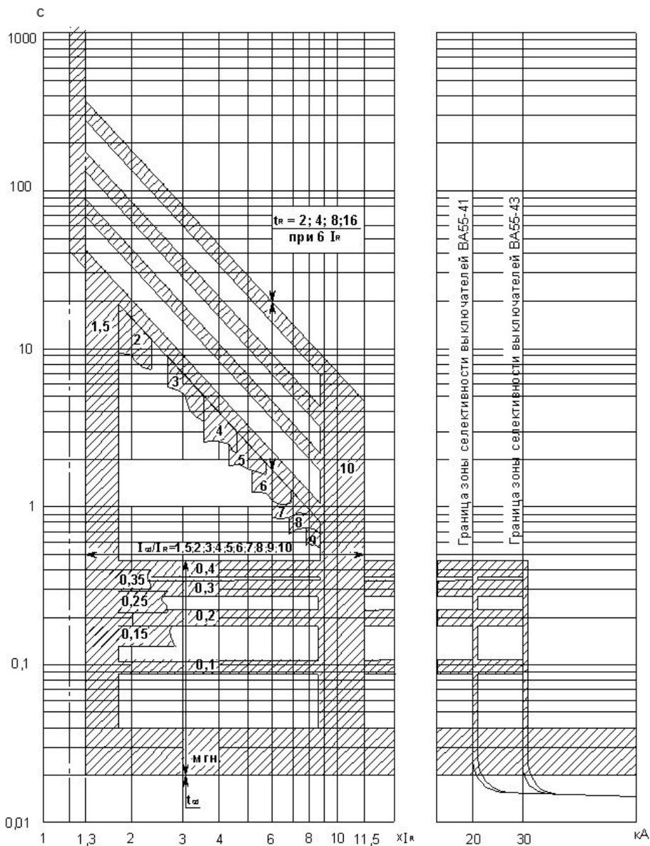
**Рисунок В.3** – Выключатель ВА55-43. Обрато-квадратичная зависимость
