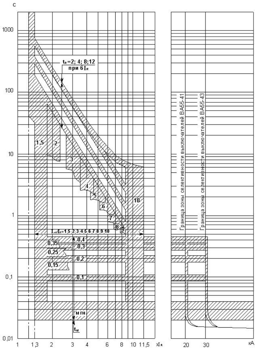
**Рисунок В.4** – Выключатель ВА55-43. Обратнo-кубическая зависимость
