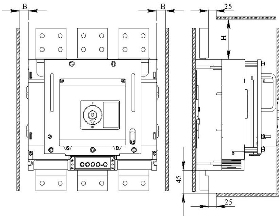
**Рисунок Д.2** – Выключатель с электромагнитным приводом
