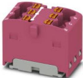
Распределительный блок, с внутренней перемычкой, Блоки можно шунтировать между собой, используя отверстия клеммы. Подходящие перемычки см. в принадлежностях, номинальное напряжение: 450 В, номинальный ток: 17,5 А, тип подключения: Зажимы Push-in, количество точек подсоединения: 6, сечение: 0,14 мм<sup>2</sup> - 2,5 мм<sup>2</sup>, AWG: 26 - 14, ширина: 12,5 мм, высота: 18,7 мм, цвет: розовый, тип монтажа: склеивание
