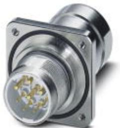
Проходная часть, задняя часть стенки, прямой, Винтовой зажим, M23, полюсов: 5+PE, тип контактов: Штифт, Обжим, Аксиальное уплотнительное кольцо, 4xM3, экранирован.: есть, диапазон диаметра кабеля: 7,5 мм ... 9 мм
