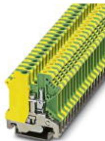
Заземляющая клемма, тип подключения: Винтовые зажимы, количество точек подсоединения: 2, сечение: 0,5 мм<sup>2</sup> - 6 мм<sup>2</sup>, AWG: 20 - 10, ширина: 6,2 мм, цвет: желто-зел., тип монтажа: NS 35/7,5, NS 35/15, NS 32
