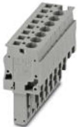
Штекер, номинальное напряжение: 800 В, номинальный ток: 32 А, тип подключения: Пружинный зажим, Штекерное подключение, количество точек подсоединения: 8, полюсов: 8, сечение: 0,08 мм<sup>2</sup> - 6 мм<sup>2</sup>, AWG: 28 - 10, ширина: 49,6 мм, высота: 41,5 мм, цвет: серый
