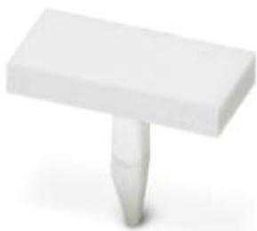
Маркировка для клеммных модулей, Гвоздь, белый, без маркировки, маркируется с помощью: CMS-P1-PLOTTER, В-стержень, тип монтажа: Вставка, для клемм шириной: 7,5 мм, размер маркировочного поля: 4 x 7,5 мм
