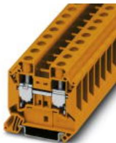
Проходные клеммы, номинальное напряжение: 1000 В, номинальный ток: 76 А, тип подключения: Винтовые зажимы, количество точек подсоединения: 2, сечение: 1,5 мм<sup>2</sup> - 25 мм<sup>2</sup>, AWG: 16 - 4, ширина: 12,2 мм, цвет: оранжевый, тип монтажа: NS 35/7,5, NS 35/15
