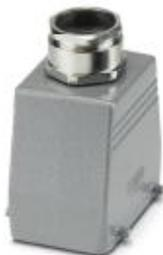
Корпус с кабельным сальником, крепление производится двумя защелками, высота 76 мм, с резьбовым соединением, 1x Pg29, прямое подключение кабеля
