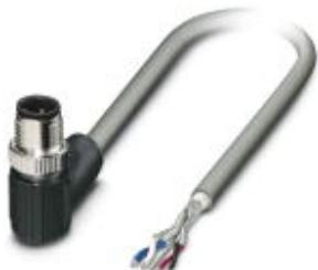
Системный кабель шины, CANopen®, DeviceNet™, 5-полюсн., ПВХ, серый, экранирован., Штекеры угловые M12 SPEEDCON, А-кодирование, к свободный конец, длина кабеля: 2 м, Соединитель неэкранированный
