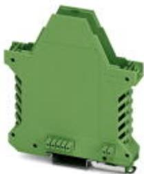
Установочный корпус, длина: 99 мм, с вентиляционными отверстиями, Нижняя часть корпуса, поперечное соединение: встроенный шинный соединитель, цвет: зеленый, ширина: 17,5 мм, высота: 114,5 мм, кол-во контактов поперечного соединителя: 5+2
