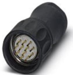
Кабельный соединитель, прямой, с пластмассовой оболочкой, экранирован.: есть, Винтовой зажим, M23, Полосов: 12, тип контактов: Штифт, Подключение пайкой, диапазон диаметра кабеля: 6,5 мм ... 7,5 мм
