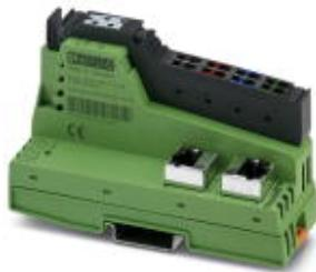
Inline, Устройство сопряжения с шиной, EtherCAT®, Гнездо RJ45, скорость передачи данных в локальной шине: 500 кбит/с / 2 Мбит/с, степень защиты: IP20, вкл. штекер Inline и поле для маркировки
