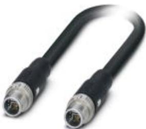
Готовый Ethernet-кабель, CAT5e, экранированный, 8 пар, гибкий AWG 26 (19-проводочный), RAL 9005 (черный), с обоих концов гибридные штекеры M12, длина 50,0 м
