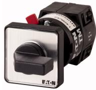
Переключатель, контакты: 2, 10 А, Передняя панель: 2>0<1, 30 °, без фиксации, Центральный монтаж
